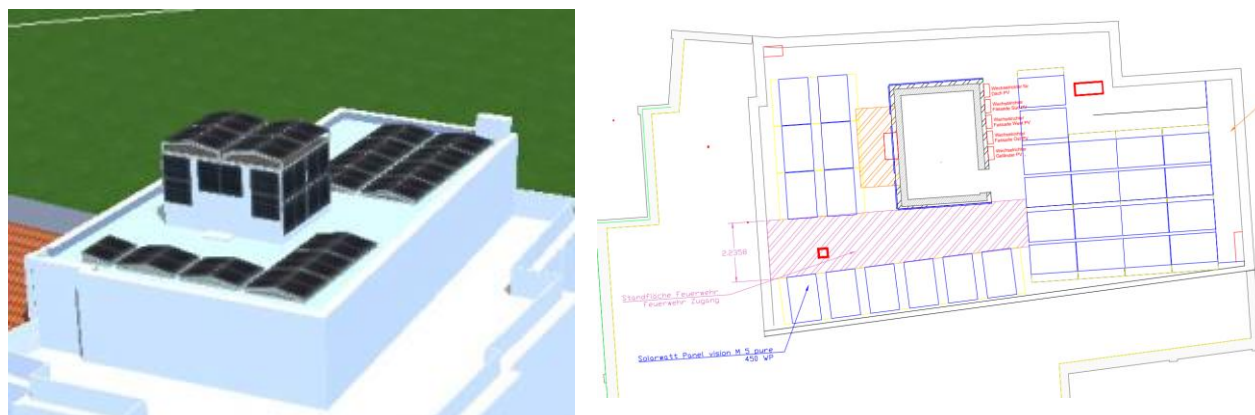
Abbildung 5: PV-Anlage am Dach und am Liftaufbau (Quelle: ATB-Becker]
