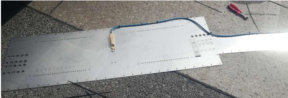
Abbildung 7: Montageblech mit Keilsensor zur kombinierten Geschwindigkeits-, Temperatur- und Füllstandsmessung
