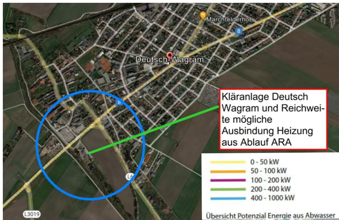
Abb29.: Übersicht Lage Kläranlage, Potenzial für Heizzwecke ab 400 kW (bei Absenkung der Temperatur im Ablauf von 3-4°C) und eingeschätzte Reichweite für mögliche Nutzung Heizung aus Ablauf ARA
