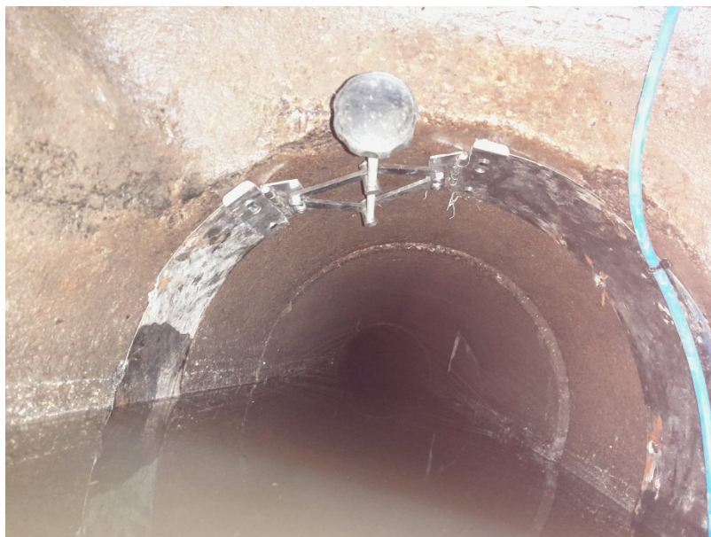
Abb. 6: Eigebautes Montageblech mit Sensor in Kanalsohle am Messpunkt nahe Gemeindezentrum
