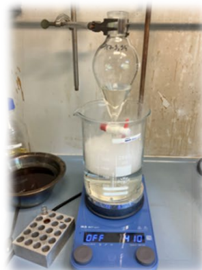
Abbildung 2: Synthese von ionischen Flüssigkeiten mit definiertem Säureüberschuss.
