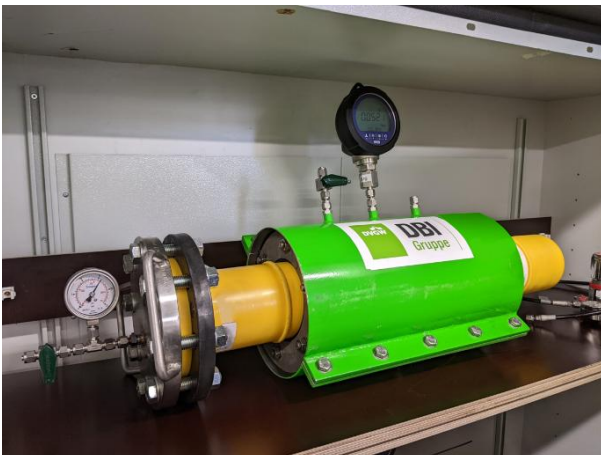
Abbildung 3: Beispielhafte Prüfaufbauten für Permeationsmessungen; links: Prüfröhr in der Messzelle, rechts: Plattenprüfkörper
