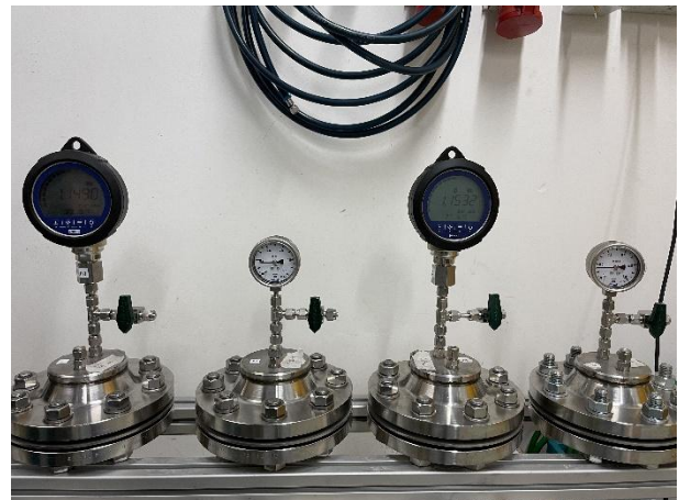
Abbildung 3: Beispielhafte Prüfaufbauten für Permeationsmessungen; links: Prüfröhr in der Messzelle, rechts: Plattenprüfkörper
