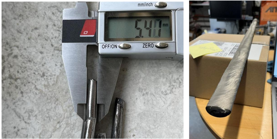
Abbildung 3.17 – Untervergebene Drahtproduktion; (links) – endgültige Drahtgeometrie; (rechts) – gegossener Stab.
