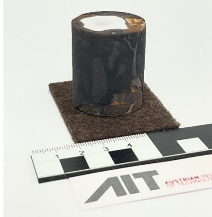
Abbildung 3.15 – Titanblock, der in Drahtstrangpressversuchen verwendet wurde, skaliert und oxidiert.
