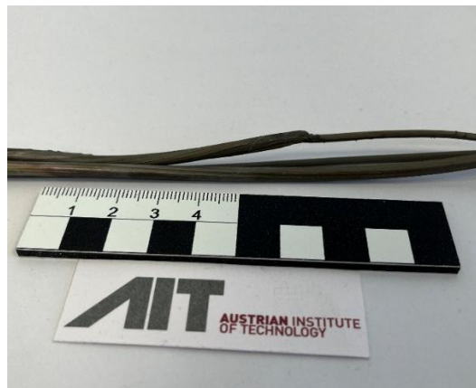
Abbildung 3.16 – Extrudierte Drähte mit unterschiedlichen Durchmessern aufgrund eines Werkzeugversagens während der Extrusion.
