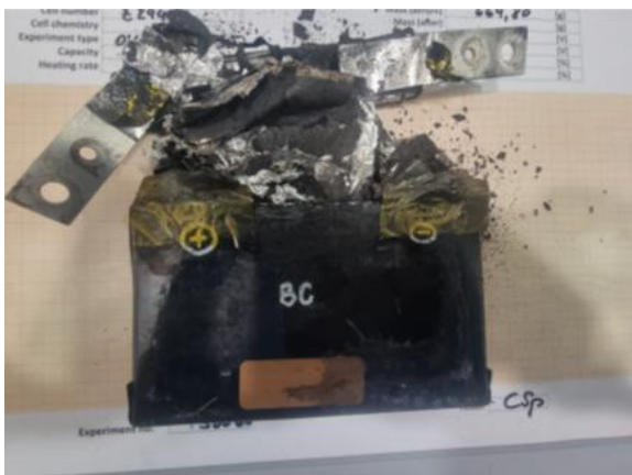
Abbildung 1: Na-Ionen Zelle nach dem Überladungsversuch. Die Zelle ist im Bereich der Berstscheibe weiter ausgebrochen.
