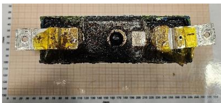
Abbildung 6: Ansicht von oben der LFPP-Zelle nach dem TR-Versuch (links). Die Vent Gas Zusammensetzung des Versuches nach dem TR (rechts).
