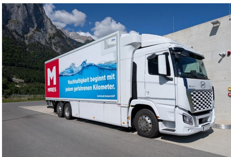
Abbildung 3: Hyundai Xcient 6x2 mit Kühlkofferaufbau von EMPL.
