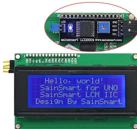
Abb. 8: LCD-Display mit I2C-Adapter 8
