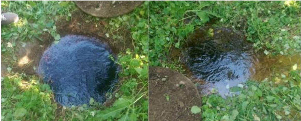
Abbildung 26: Schacht AL-0 und Schacht AL-01 am Ende des Versuchszeitraumes bei einem Durchfluss von 5.000 l/min
