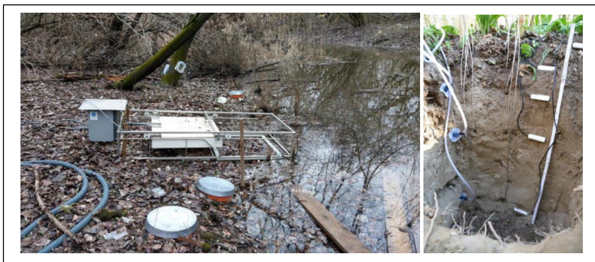
Abbildung 4: Links: Manuelle THG-Kammern (Im Vordergrund; orange, mit silbernen Deckeln verschlossen), Autokammer (Mitte) und Stammkammern (Hintergrund) an einem der drei Intensivstandorte. Rechts: Instrumentierung mit Saugkerzen, Stahlkapillaren zur Bodenluftprobenahme und Temperatur- sowie Feuchtigkeitssensoren in verschiedenen Bodentiefen.
