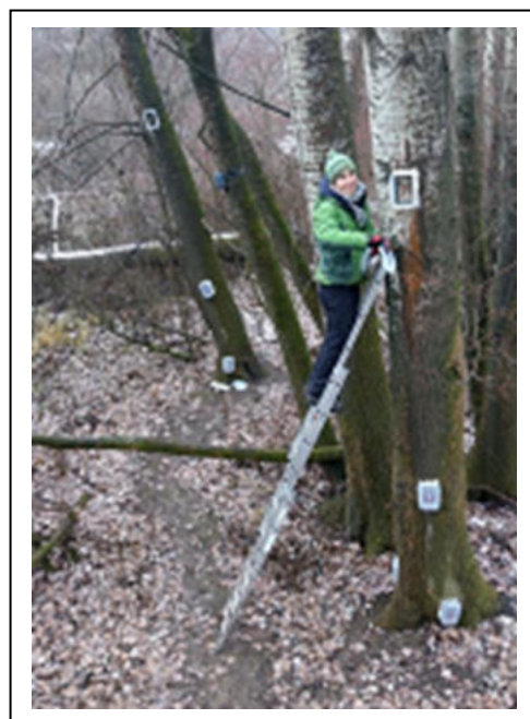
Abbildung 15: Baummesskammern Zur Erfassung der Treibhausgas- Flüsse aus Baumstämmen.
