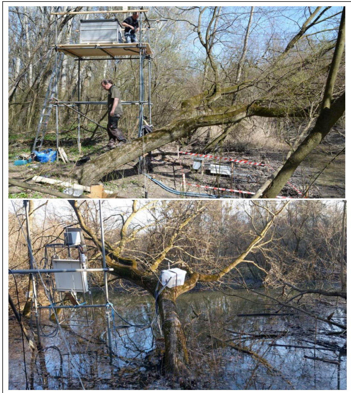
Abbildung 13: Intensivbeobachtungsfläche Stopfenreuth III. Technisch sensible Geräte wurden auf einem eigens errichteten Turm installiert, um sie vor Überflutung (unten) zu bewahren.
