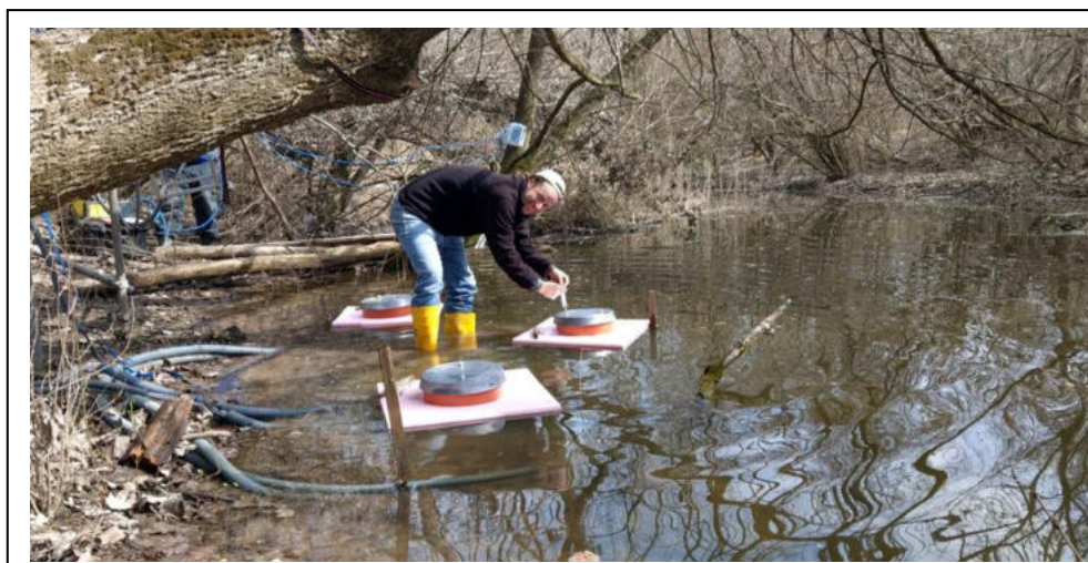
Abbildung 14: Schwimmkammern zur Messung der THG-Flüsse an Wasseroberflächen (die THG-Flüsse waren minimal).
