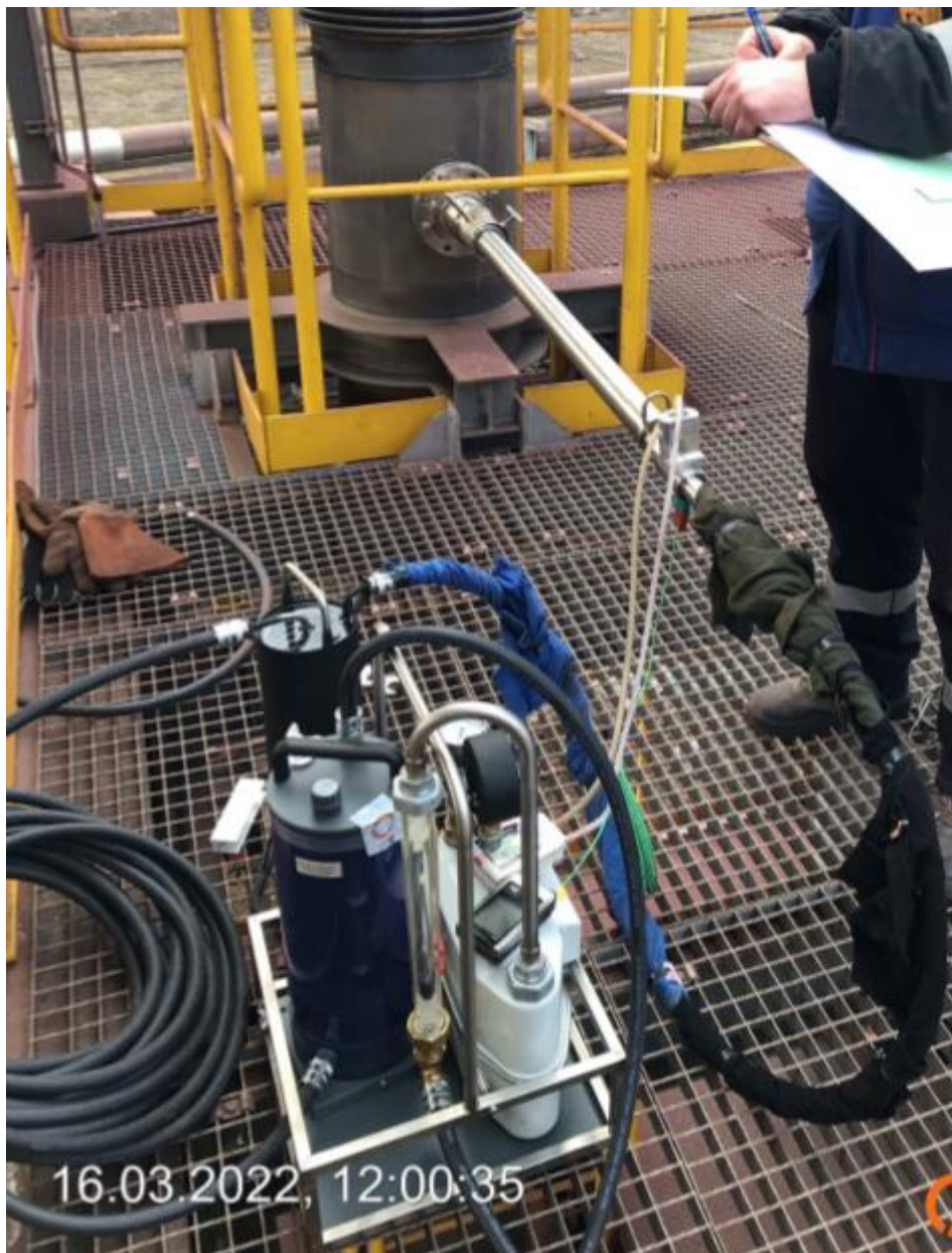
Abbildung 9 - Aufbau der Staubmessung im Zyklonabgas
