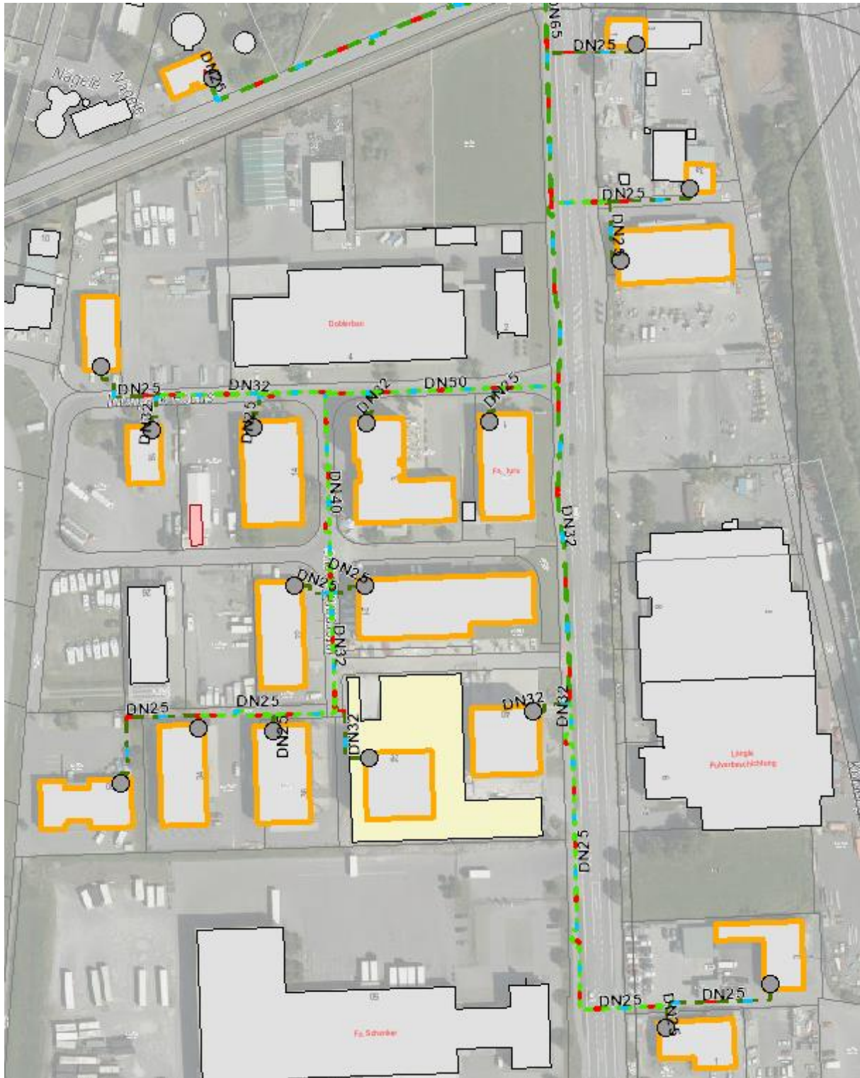
Abbildung 11 - Berechnetes Nahwärmenetz (Quelle: Netzinformationssystem Vorarlberger Energienetze GmbH)
