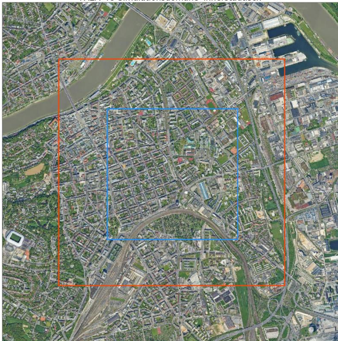
Abbildung 3: PALM-4U Simulationsdomäne der Ortslage „innerstädtisch“. Äußerer Rahmen (orange): Parent Domain, Auflösung: 10 m; Innerer Rahmen (blau): Child Domain, Auflösung: 5 m.
