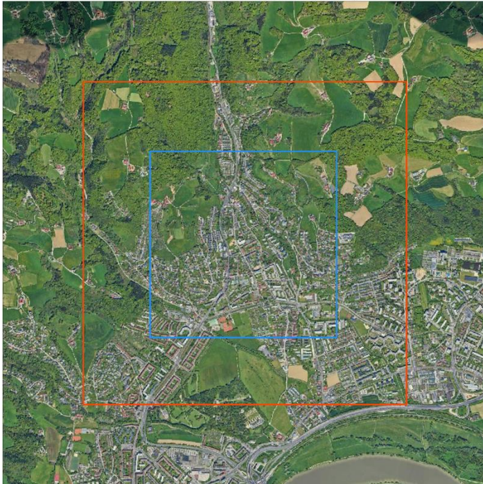
Abbildung 2: PALM-4U Simulationsdomäne der Ortslage „Stadtrand“. Äußerer Rahmen (orange): Parent Domain, Auflösung: 10 m; Innerer Rahmen (blau): Child Domain, Auflösung: 5 m.
