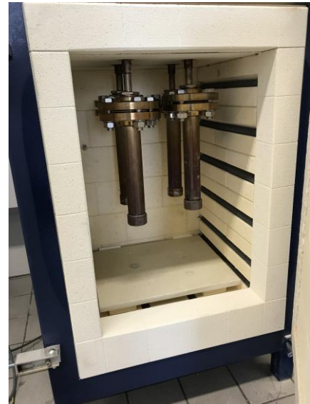
Abbildung 13: Adaptierter Makro-TGA-Aufbau für Carbonatisierung von Ascheproben
