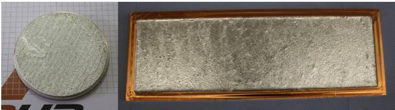
Abbildung 15: Versuchstarget aus 3 Zoll aus In-Ga-Cu Legierung nach Endbearbeitung direkt gebondet auf einem Kupferträger sowie Versuchstarget mit Großformat (rechts) direkt nach Herstellung.
