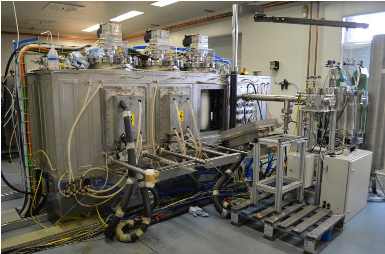
Abbildung 4: Ein Highlight des ersten Projekts war die Erweiterung einer - Rolle-zu-Rolle Hybrid Sputtering/Verdampfungsanlage zur Herstellung von CIGS Absorberschichten auf flexiblen Substraten mit externem Feststoffverdampfer zur Versorgung mit hochreaktivem Selen. Die externe Selenquelle wurden im ersten Projektjahr geplant und integriert und in der 2. Projektperiode optimiert (v.a. Gasfluss und Temperaturregelung).
