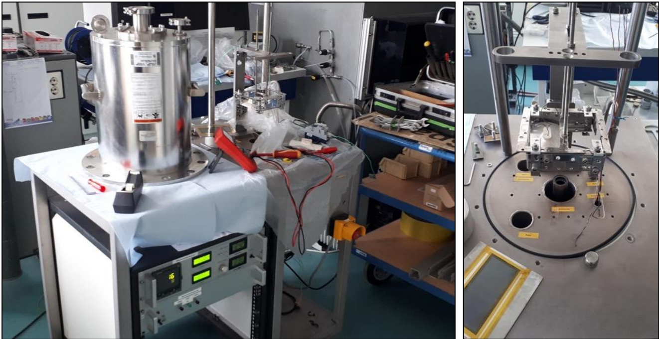
Abbildung 14: Von Sunplugged entwickelte Vakuumanlage zur Durchführung von Nachbehandlungen
