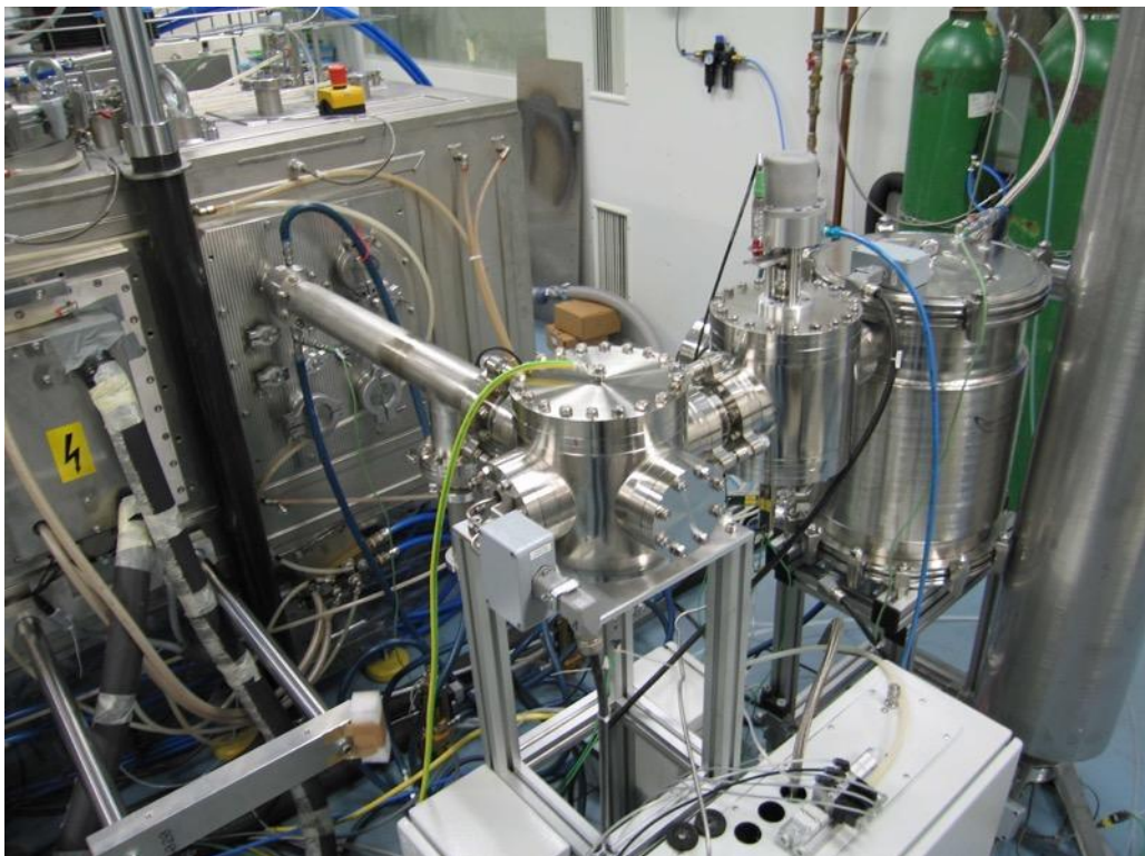
Abbildung 3: Integration eines externen Feststoffverdampfers (Dr. Eberl MBE-Komponenten GmbH) in die CIGS-Beschichtungsanlage.
