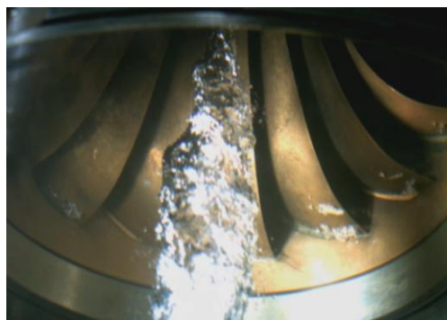
Abbildung 16: Kavitationszonen bei Q = 270 l/s und \text{Sigma} = 0.18 in Simulation (links) und am Modell (rechts)
