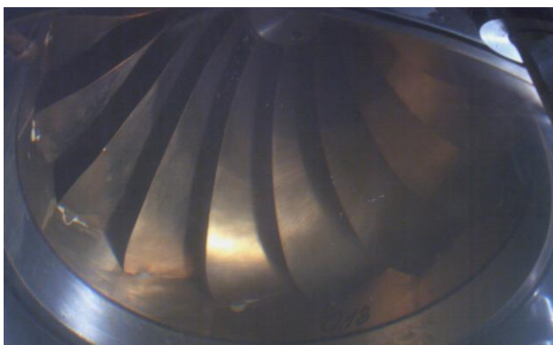
Min. beginnende Kavitation bei \sigma = \text{ca. } 0.45
