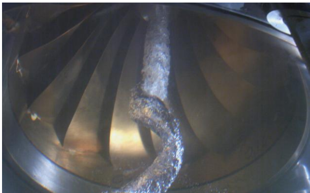
Ausgeprägte Kavitation bei \sigma = \text{ca. } 0.12 (Laufschaufeln noch immer kavitationsfrei)
