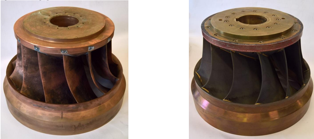
Abbildung 28: Fotografischer Vergleich des originalen (links) und optimierten (rechts) Laufraddesigns
