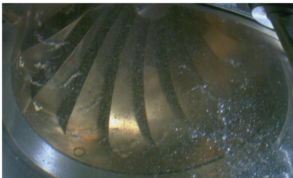
Ausgeprägte Kavitation bei \sigma = \text{ca. } 0.15
