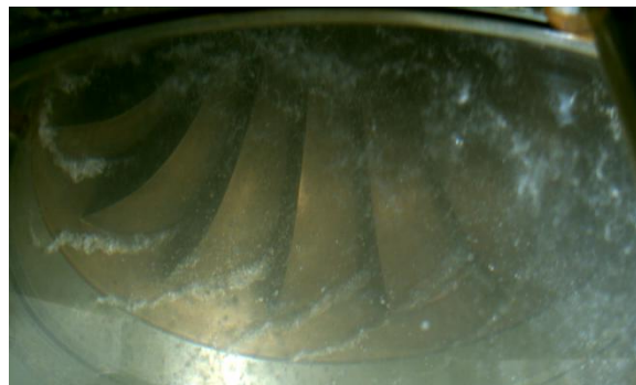
Sehr stark ausgeprägte Kavitation bei \sigma = \text{ca. } 0.15
