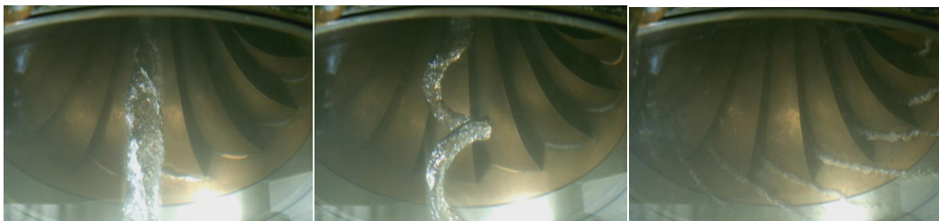
Abbildung 10: Kavitationsphänomene im Saugrohr der Francis-Modellturbine bei H = 13.1 m und \Sigma = 0.3 (Links: Volllastzopf / Mitte: Teillastwirbelzopf / Rechts: kavitierende Kanalwirbel)
