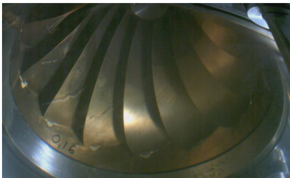
Beginnende Kavitation bei \sigma = \text{ca. } 0.35
