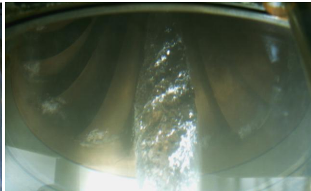
Sehr stark ausgeprägte Kavitation bei \sigma = \text{ca. } 0.20 (Kavitation an Laufschaufeln klar ersichtlich)
