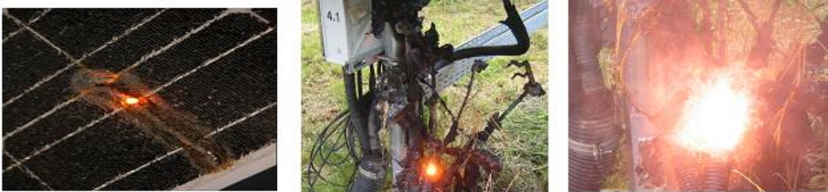
Abbildung 1: Beispiele zu real auftretenden Lichtbögen (links: Aufschmelzen einer schadhafte Kontaktstelle direkt im PV Modul, mitte und rechts: Brand am Stranganschlusskasten).
