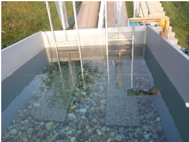
Abbildung 13: Unterwasserbecken mit Kiesschicht und Waschbetonplatten
