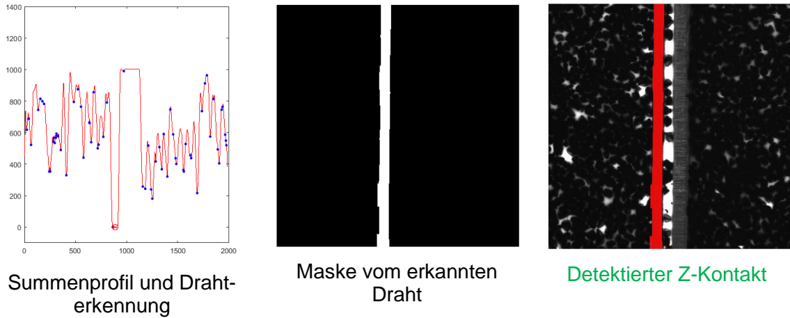
Abbildung 12 Zwischenergebnisbilder der Z-Kontakterkennung
