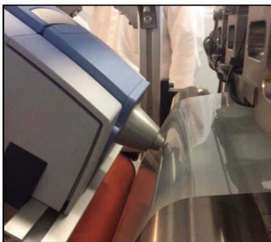
Abbildung 35 - FTIR Spektrometer Montage: Detailaufnahme und Skizze der Einbausituation
