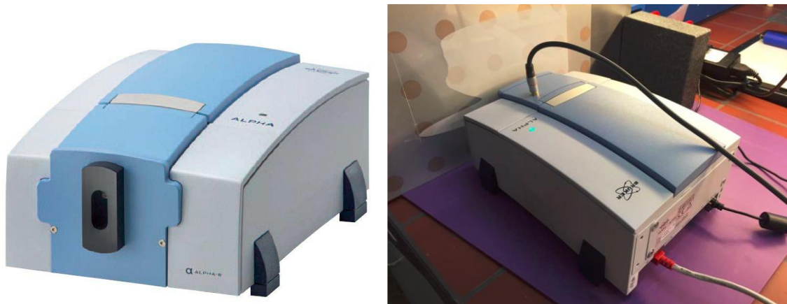
Abbildung 8 - FTIR Spectrometer von Bruker – (rechts) Testaufbau Auflösungstest
