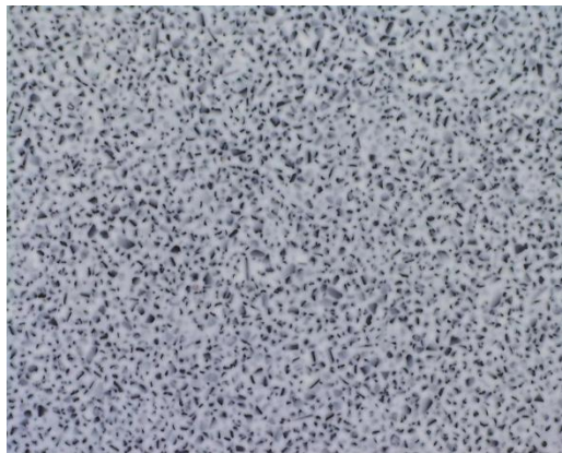
Abbildung 20 – typisches Einpressbild vor dem Schleifen der MG
