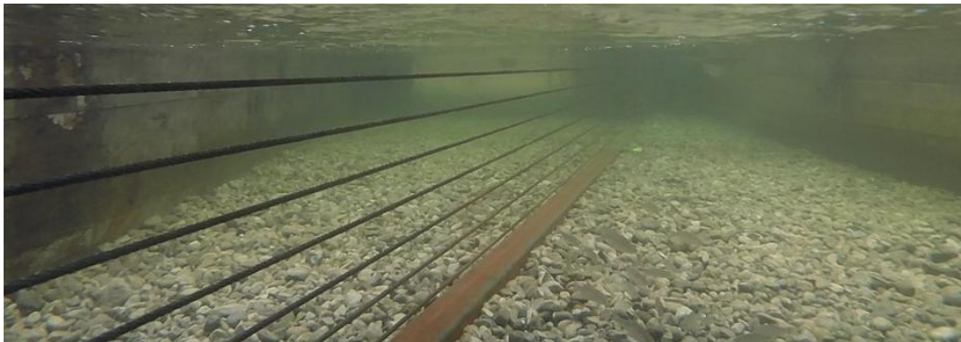
Abbildung 11: Auszug aus den durchgeführten Versuchen – Fische welche sich gegen die Strömung ausgerichtet haben und durch den Elektro-Seilrechen (Anstellwinkel 20°, lichter Seilabstand 60 mm) geschützt werden
