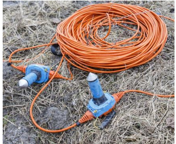
Abbildung 2: Information der Bevölkerung während der Messungen (links); Digitale 3-Komponenten Aufnehmer (rechts)
