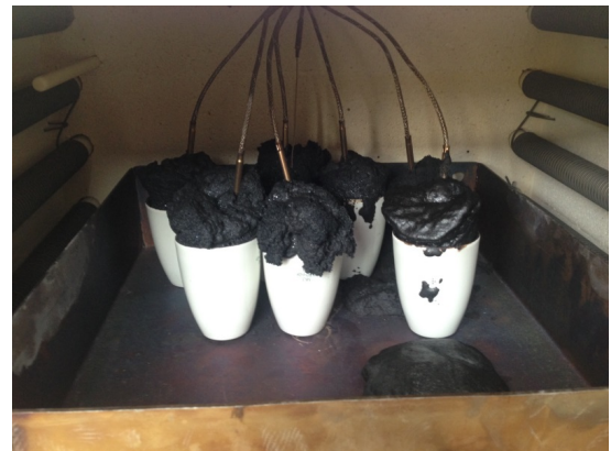
Abb.: 11 Zerstörte und aufgeschäumte Mikropartikelproben nach mehrfacher thermischer Belastung
