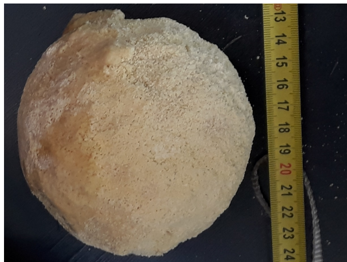
Abb. 8: Coatingergebnis bei Verwendung nicht günstiger Herstellungsparameter
