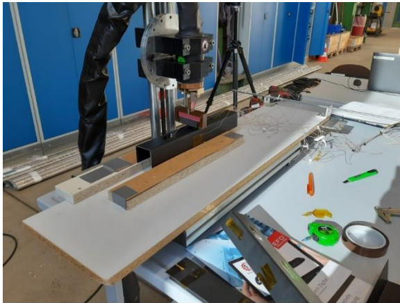
Abbildung 2: a) Werkstück und Induktionsspule; b) Verwendetes Induktionsgerät
