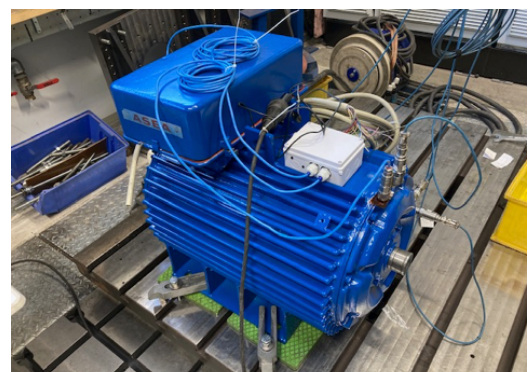
Abbildung 31: Testmotor mit installiertem ConSens Demonstrator (weisse Box) und Vibrationssensoren an der Motorvorderseite.
