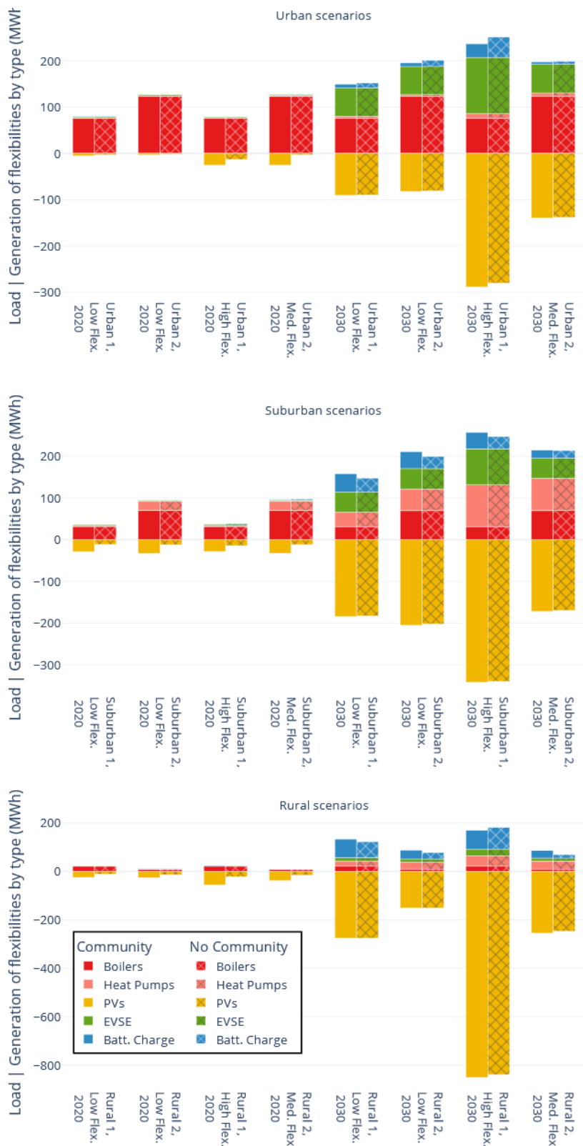
Abbildung 22: Jährlich aggregierte Last bzw. Erzeugung für den "Community" und den "No Community" Fall für alle Szenarien. Quelle: [25]
