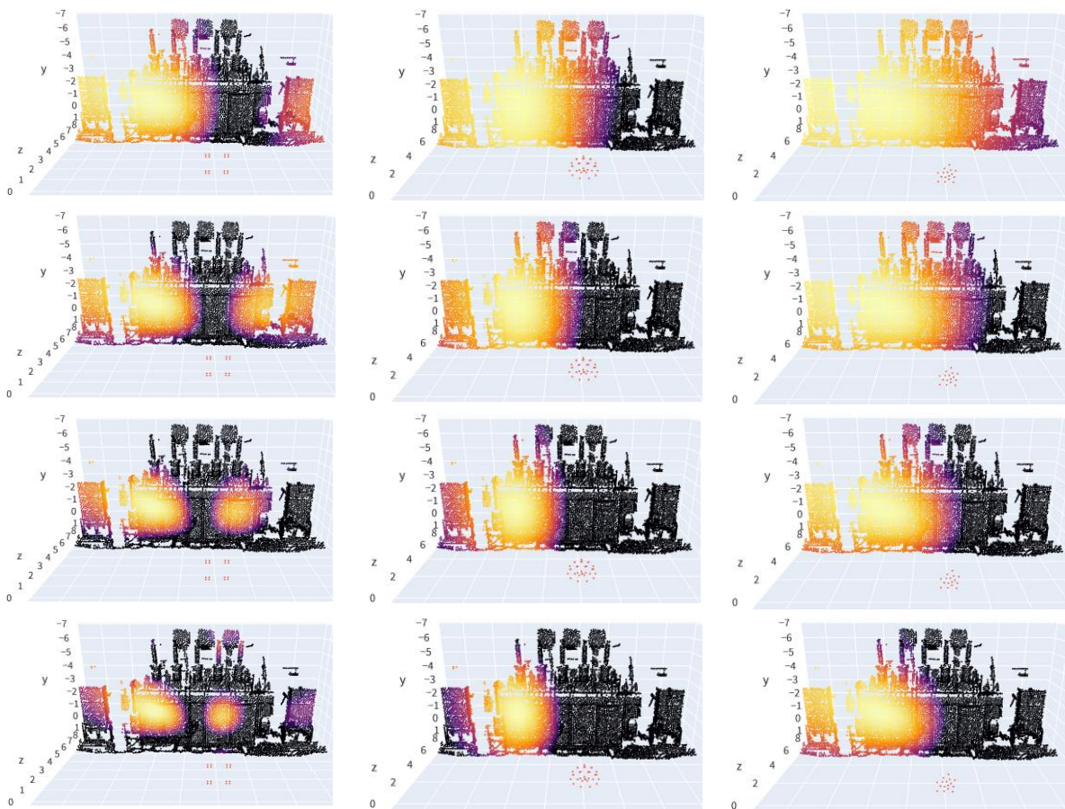
Abbildung 19: Vergleich der verwendeten Array Geometrien. In den Spalten sind die Arrays SmallGrid16 (links), IcoDome32L (mitte) und Sunflower16 (rechts) dargestellt. Die Reihen enthalten die verschiedenen Frequenzen, von oben nach unten, 100 Hz, 200 Hz, 300 Hz, 400 Hz und 500Hz.
