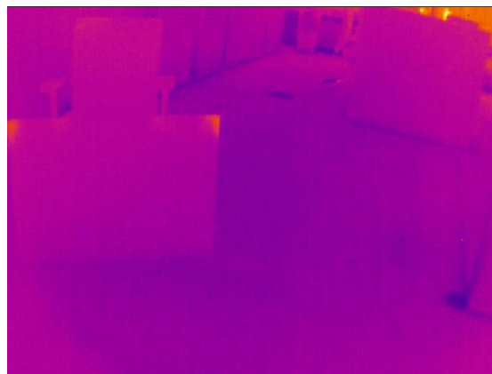
Aufnahme derselben Szene mit einer Thermalkamera (Schachbrettmuster ist nicht erkennbar)
