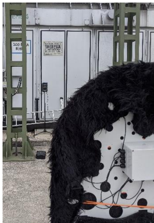
Abbildung 41: Messaufstellung mit Störquelle (links) und Output des Modells zur Veränderungsdetektion für den gesamten Frequenzbereich.
