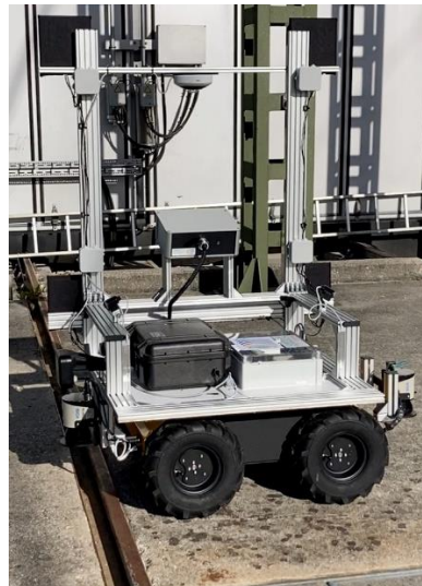
Abbildung 14: SmallGrid16 montiert auf der autonomen Plattform in Obersielach.
