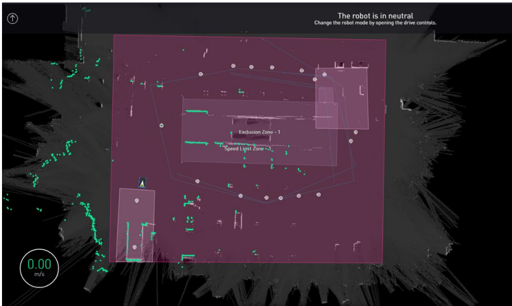
Abbildung 57: Karte zur autonomen Navigation der Plattform. Die grauen Abbildungen stellen bereits bekannte Objekte dar, die grünen Punkte sind die aktuellen Sensorinformationen. Die kleinen Kreise sind die Punkte, an denen die Messungen durchgeführt werden
