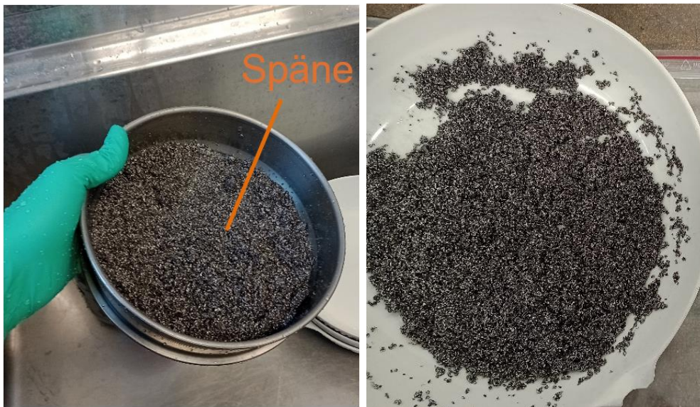
Abbildung 3-13: Späne nach dem Reinigen (links) und nach dem Trocknen (rechts).
