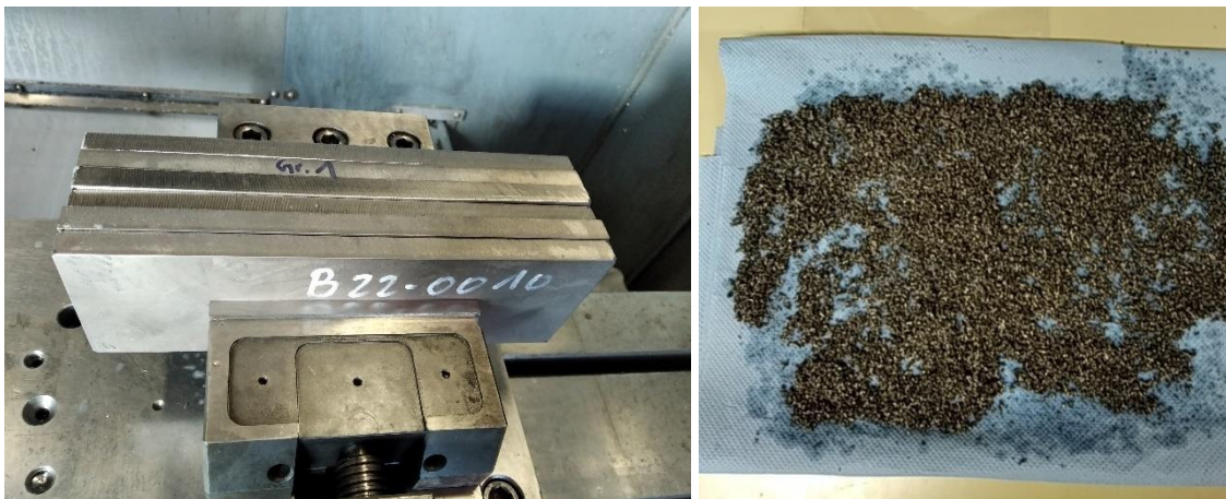
Abbildung 3-3: Eingespannte Titanplatten, die mit verschiedenen Parametern gefräst wurden (links) und daraus hergestellte Späne (rechts).
