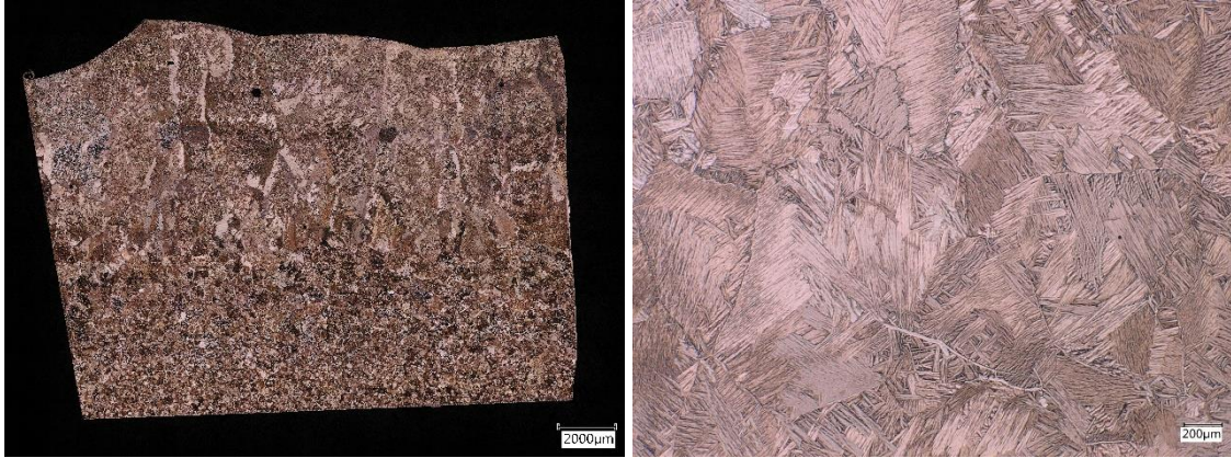
Abbildung 3-27: Links: Geätzter Querschliff eher am Ende der Probenlänge, unten ist das Substrat, oben die aus Spänen aufgebaute Schicht zu sehen; Rechts: Aufnahme der Schicht aus Spänen mit höherer Vergrößerung eher am Beginn der Probe.
