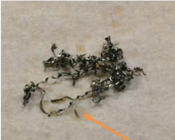
Abbildung 3-9: Unzureichend gereinigte Späne hinterlassen ölige Flecken, wenn sie einige Zeit auf Filterpapier liegen (hier: Ti-6Al-4V mit 1 mm Frästiefe).
