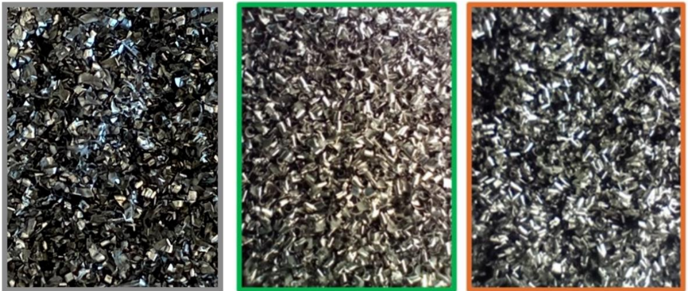
Abbildung 3-14: Ungereinigte Späne (links) sowie mit Methode 1 (mittig) und der weniger erfolgreichen Methode 2 (rechts) gereinigte Späne.
