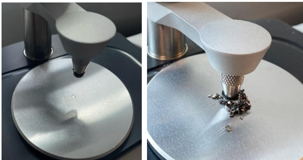
Abbildung 3-10: Sensor des Infrarot-Spektrometers ohne Späne (links; die Messung passiert auf dem kleinen Punkt in der Mitte der Platte) und mit Spänen (rechts).
