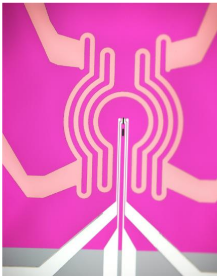
Abb. 21. Lichtmikroskopische Aufnahme des MEMS Chip für die Messung der elektrischen Eigenschaften während gleichzeitigem Heizen. Die 4 Kontakte für die Messung der elektrischen Eigenschaften sind weiß und die Heizspule ist Gold. Die Probe wird über die elektrischen Kontakte in der Mitte der Heizspule gelegt.
