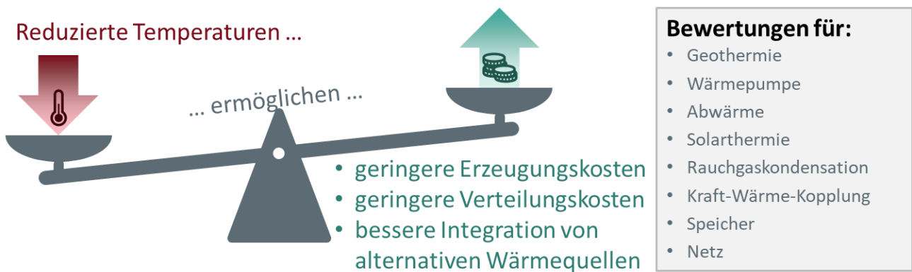
Abbildung 79: Übersicht über die positiven Auswirkungen auf die reduzierten Systemtemperaturen und den Umfang der Bewertungen (Quelle: Geyer et al., 2021)
