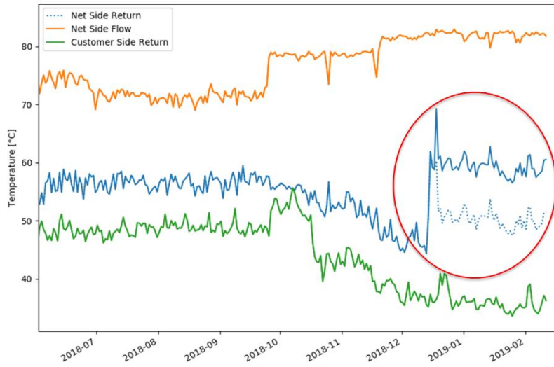
Abbildung 22: Testdaten eines Wärmeabnehmers, wo sich die Rücklauftemperatur aufgrund eines Fehlers sprunghaft verschlechtert
