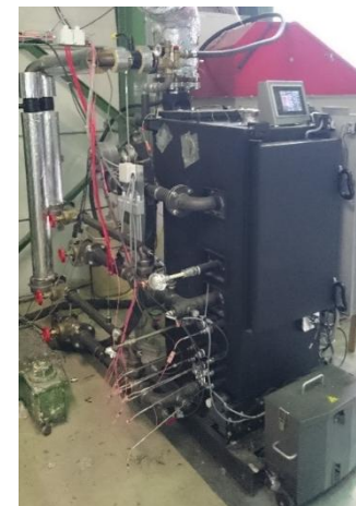
Abbildung 2: Vereinfachte schematische Darstellung des Prüfstandsbaus und der verwendeten Messgeräte in der Primär-, Sekundär- und Tertiärluftmessstrecke, der Primär- und Sekundärrezi-Messstrecke und der Abgasmessstrecke (links) [2] sowie realisierter Prüfstand mit 30 kW Laborreaktor von der rechten und linken Seite gesehen (rechts oben und rechts unten)
