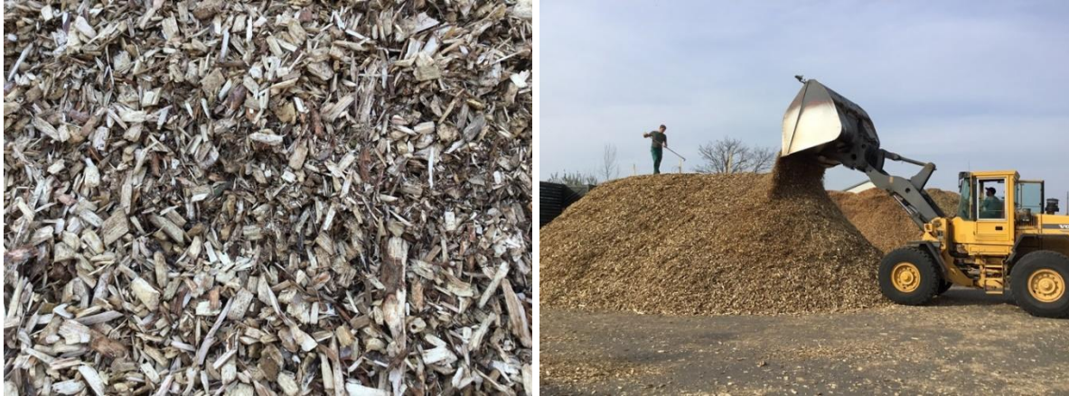
Abbildung 10: Pappelhackgut (links) und Aufbau der Haufwerke (rechts).
