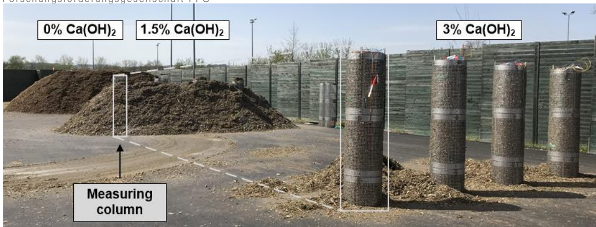
Abbildung 1: Testhaufwerke (Lagerversuch 1, Fichtenwaldhackgut) und die eingearbeiteten Probennahmesäulen.
