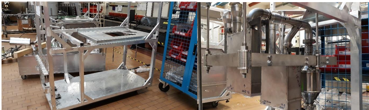
Abbildung 66: Rahmen des SOFC CHP Systems (links), integrierte der Gasaufbereitungseinheit mit Abstüzungsgürtel.
