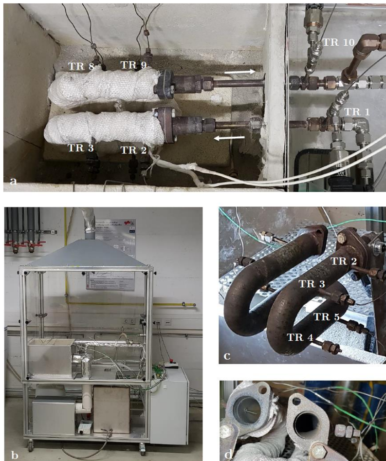
Abbildung 57: Prüfstand für die Ammoniakreformierung. Bild a zeigt den Reformer im befüllten und eingebauten Zustand im Prüfstand (Bild b). Die Box um den Reaktor wurde während der Messungen mit thermisch isolierendem Granulat befüllt. Die Strömungsrichtung des Gases wird durch die weißen Pfeile angezeigt. Bild c zeigt den blanken Reaktor mit den Temperaturmessstellen und Abbildung d verdeutlicht die Position der Thermoelemente innerhalb des Rohres.
