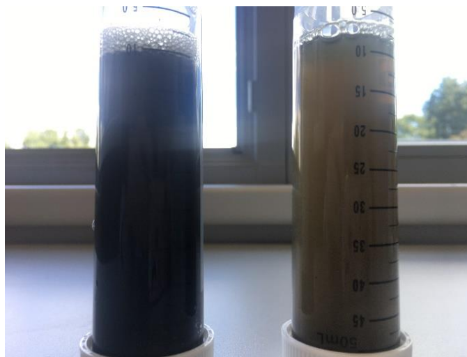
Abbildung 27: Proben der geflochtenen Gärreste, links Probe 2 - 0,03 kg Fe/kg TS weist gut erkennbar noch einen deutlich höheren Schwebstoffgehalt als rechts die Probe 3 - 0,06 kg Fe/kg TS
