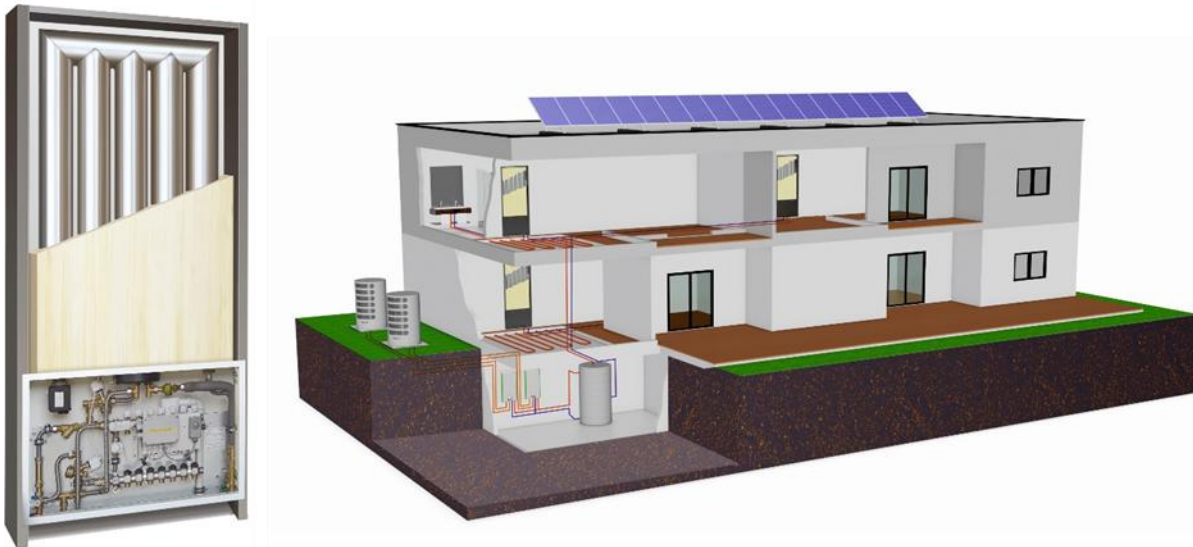
Abbildung 5: Schematische Darstellung des Aufbaus des enerboxx-Systems
